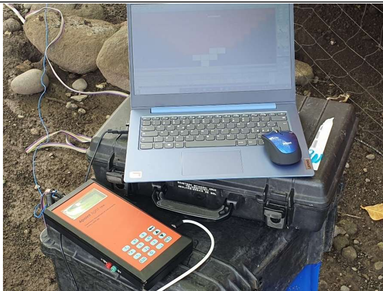
Figure 4 : Photographie du résistivimètre LIPPMAN utilisé pour les mesures
